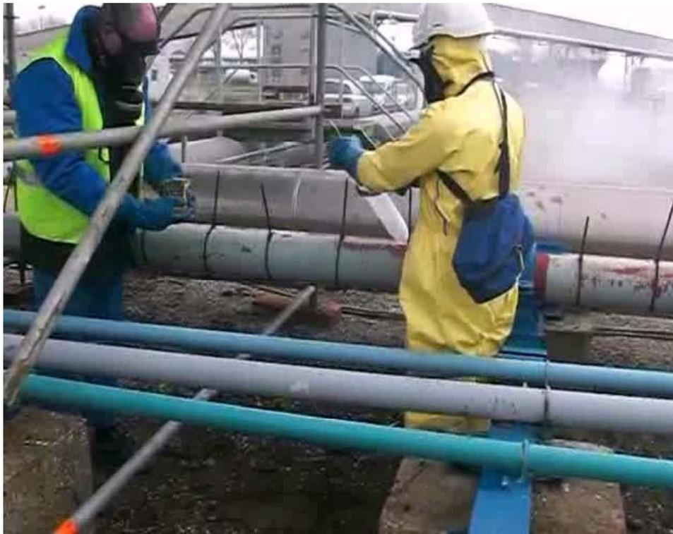
**Figure 3:** *Ammonia pouring test setup.*
