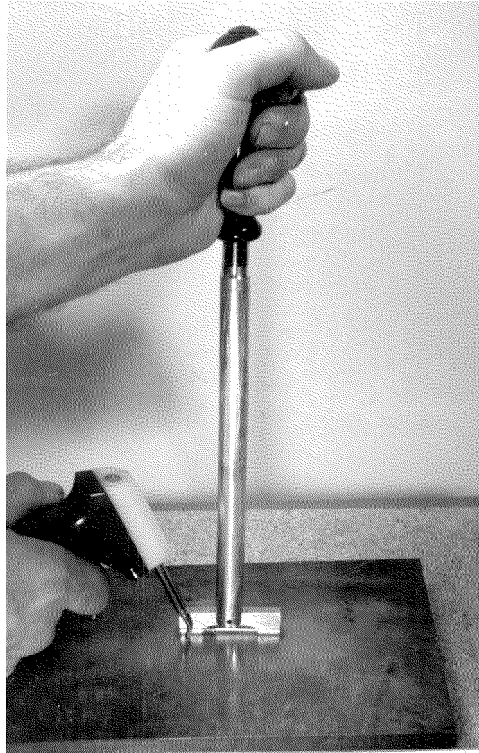
Figure 4 Installation de la jauge avec le gabarit
