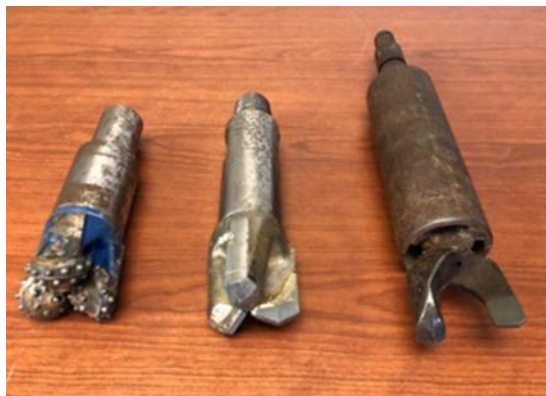
Figure 2. Outils de coupe généralement utilisés : outil à rouleaux type tricône et outil à lames. Exemple d'outil modifié : outil à deux lames avec tube de guidage
