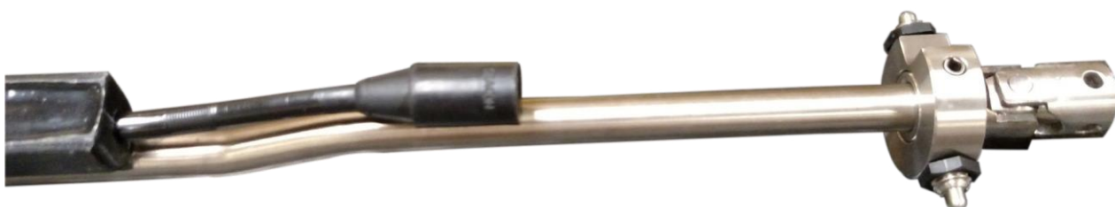
Figure 4: GeoString noeud inférieur (connecteur femelle avec joint universel)
