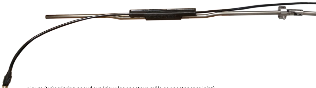
Figure 3: GeoString noeud supérieur (connecteur mâle connector sans joint)
