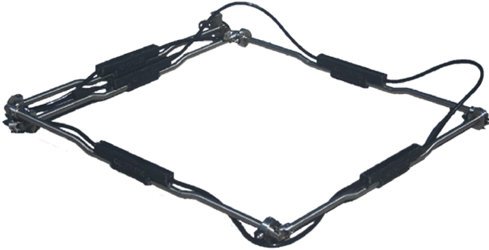
Figure 1: GeoString segment plié pour le transport
