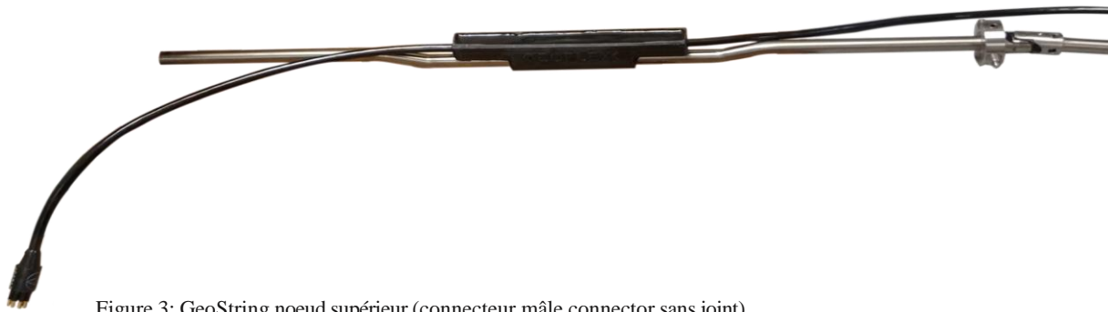
Figure 3: GeoString nœud supérieur (connecteur mâle connector sans joint)
