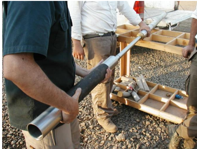
Remplacement de la gaine du PROBEX
